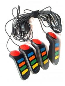
Ensemble de 4 buzzers (5 boutons par buzzer) sur une seule connexion USB. Le contrôleur est reconnu facilement sur linux, comme périphérique HID, on peut retrouver le mapping des boutons avec https://hardwaretester.com/gamepad
