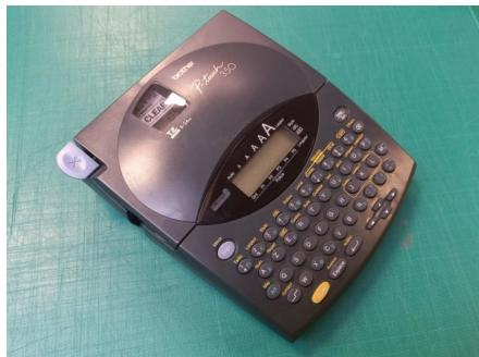
Petite imprimante thermique autonome (on ne peut pas la relier à un ordi) pour imprimer des étiquettes. Une cartouche spéciale est nécessaire pour la faire fonctionner. Le procédé permet d'obtenir des étiquettes très résistantes (eau, huile, produits chimiques, lumière, etc.).
