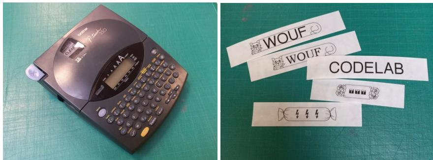
Petite imprimante thermique autonome (on ne peut pas la relier à un ordi) pour imprimer des étiquettes. Une cartouche spéciale est nécessaire pour la faire fonctionner. Le procédé permet d'obtenir des étiquettes très résistantes (eau, huile, produits chimiques, lumière, etc.).
