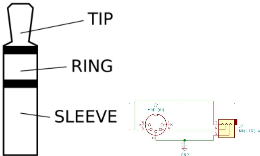
Sur le schéma, la prise MIDI est vue de l'arrière, au niveau des broches à souder
