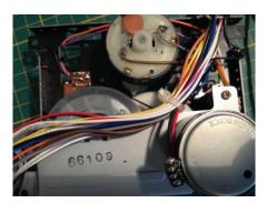
• Il faut maintenant bloquer la patte tordue du ressort en allant la bloquer dans l'encoche prévue à cet effet sur le cache moteur, juste à côté de la vis
