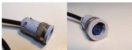
On remet un câble au connecteur chelou non-identifié de la prise secteur, temporairement pour tester l'enceinte, il faudrait plutôt un câble électrique avec une section de 2.5 mm<sup>2</sup>
