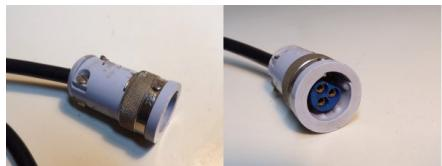
On remet temporairement un câble au connecteur chelou non-identifié de la prise secteur, pour tester l'enceinte. Il faudra plutôt choisir un câble électrique de section adaptée : 2.5 mm<sup>2</sup>
