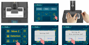
Calibration de l'imprimante Anycubic Photon Mono 4K
