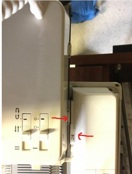
2. Allumer la machine, appuyer sur "pas à pas", appuyer sur "CE" pour vider la mémoire, entrer le numéro de motif, appuyer sur "pas à pas" 2x jusqu'à ce que la diode verte en face de "prêt" soit allumée.
