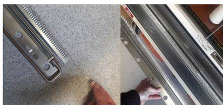
maintenir le peigne de tension avec une main et glisser la tige métallique dans le peigne de tension de façon à qu'il repose sur le fil
