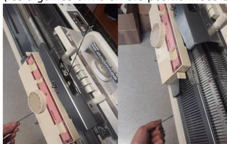
le fil de couleur principal s'est alors positionné sur les aiguilles des fontures principale et avant en zigzag
