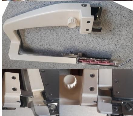
fixer le bras métallique à l'extrémité gauche de la fonture principale à l'emplacement de la barre de mousse
