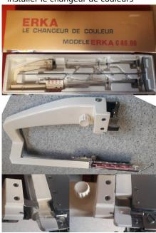
fixer le bras métallique à l'extrémité gauche de la fonture principale à l'emplacement de la barre de mousse il faut pousser légèrement la barre de mousse vers la droite pour dégager l'emplacement pour le bras métallique visser ensuite le bras métallique une fois positionné sur la fonture principale
