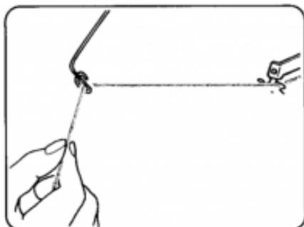
④ Faites passer le fil dans l'œillet du ressort de tension.
