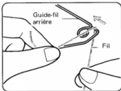
① Faites passer le fil en partant de la sphère et, en passant par le guide-fil arrière, faites le glisser à travers l'œillet.
