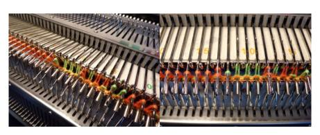
Au passage des chariots, 2 mailles se forment sur l'aiguille de la fonture principale. Problème de tension ?
